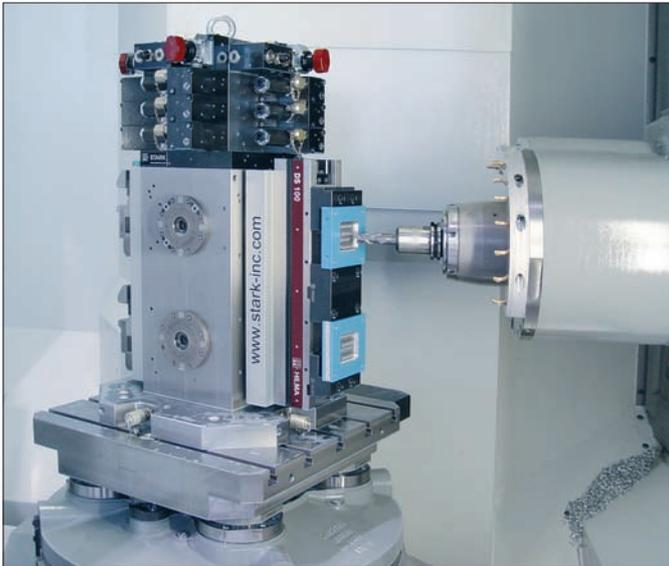
Spannturm bestückt mit **SPEEDY** classic, sowie Kupplungen mit Abblasung und integrierter Auflagekontrolle
