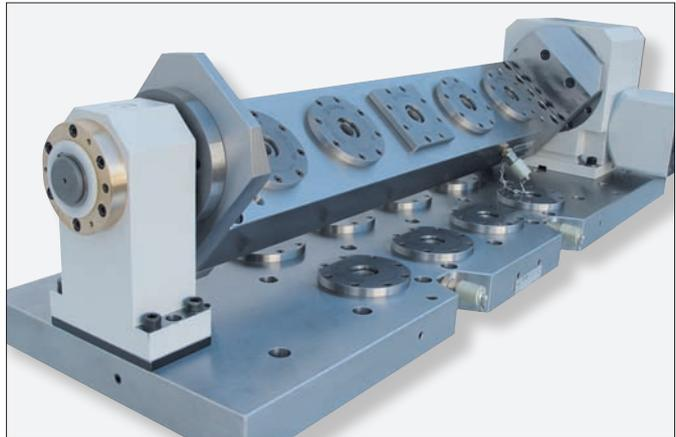
Variable, abnehmbare Spannbrücke für Einzel-, Groß- und Kleinteile
