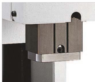
Čtyřhranný beran s dvoustranně nastavitelnými vodicími lištami bez vůle, přesným otvorem k uchycení nástroje a s dodatečnými adaptačními otvory.
