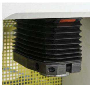
Kulatý beran se zabezpečením proti přetočení se snímačem horního mrtvého bodu (74/76) resp. systémem měření dráhy (374 / 376) na pojistné tyči.
