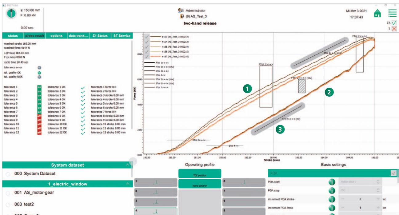
1 + 2 Alle Toleranzen können auch invertiert eingesetzt werden (Sperrbereiche). 3 Wegtoleranzen sind an Kurvensteigung anpassbar.
