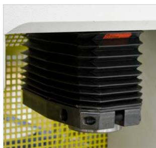
Verdrehgesicherter Rundstößel mit OT-Schalter (74/76) bzw. Wegmesssystem (374/376) an der Sicherungsstange
