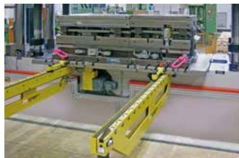
An die Presse adaptiertes Werkzeug-Wechselsystem
