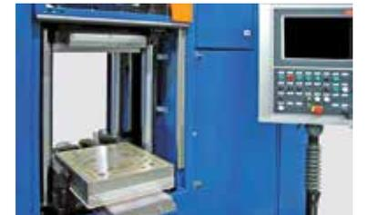
Magnet-Spannsysteme M-TECS 240
