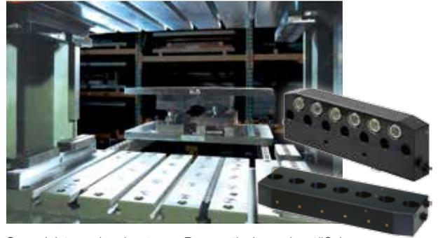
Spannleisten eingebaut an Pressentisch und -stößel. Leichte Zuführung der Werkzeuge durch Wechselkonsolen und Rollenleisten in den T-Nuten des Pressentischs
