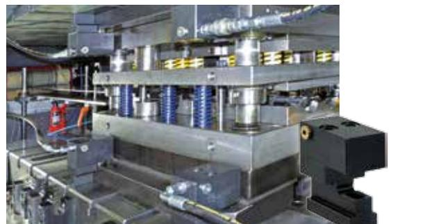
Einschubspanner mit T-Nutenfuß in Pressentisch und Stößel, Rollenleisten und Tragkonsolen für den Werkzeugschub
