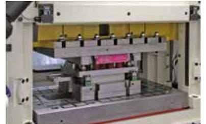
Magnet-Spannsysteme M-TECS 80
