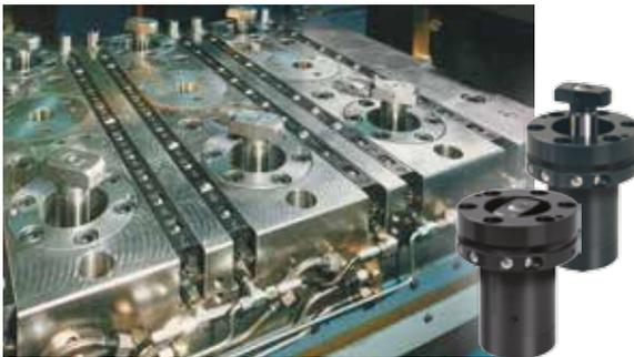
Schwenk-Senkspannelemente in einer Doppelständerpresse (Zuganker ausgefahren in Schwenkposition)
