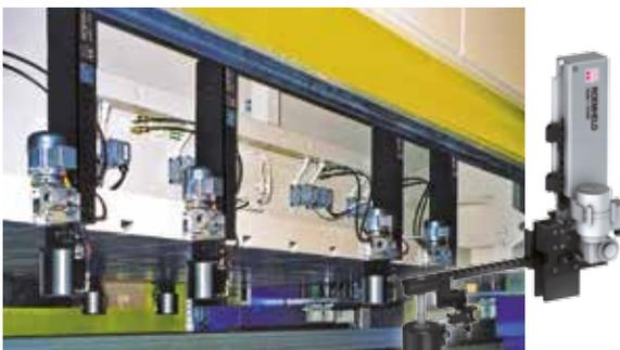
Elektrische Schnellspannsysteme mit Schubkette am Pressenstößel einer Doppelständerpresse
