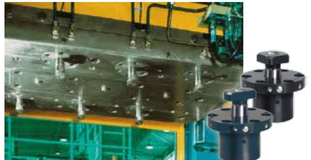
Schwenkspannelemente im Pressenstößel. Werkzeugwechselposition; Stößel in oberer Stellung, Schwenkspanner ausgefahren
