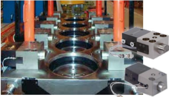
5-stufige Gesenkschmiede ausgestattet mit Keilspannelementen (mit Wegesitzventilen) zur Ansteuerung der einzelnen Stufen
