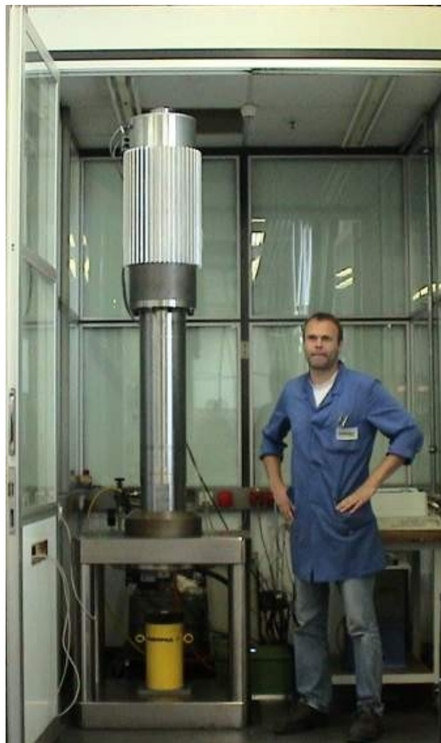
Modul ve zkušebním provozu 19.000.000 silových cyklů do prosince roku 2008
